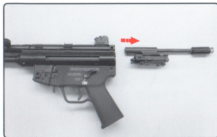
注意若要将槍機組組合回去,首先要先將下槍身定位(擊鎚下壓),否則若槍機先進入時連發桿會卡死
